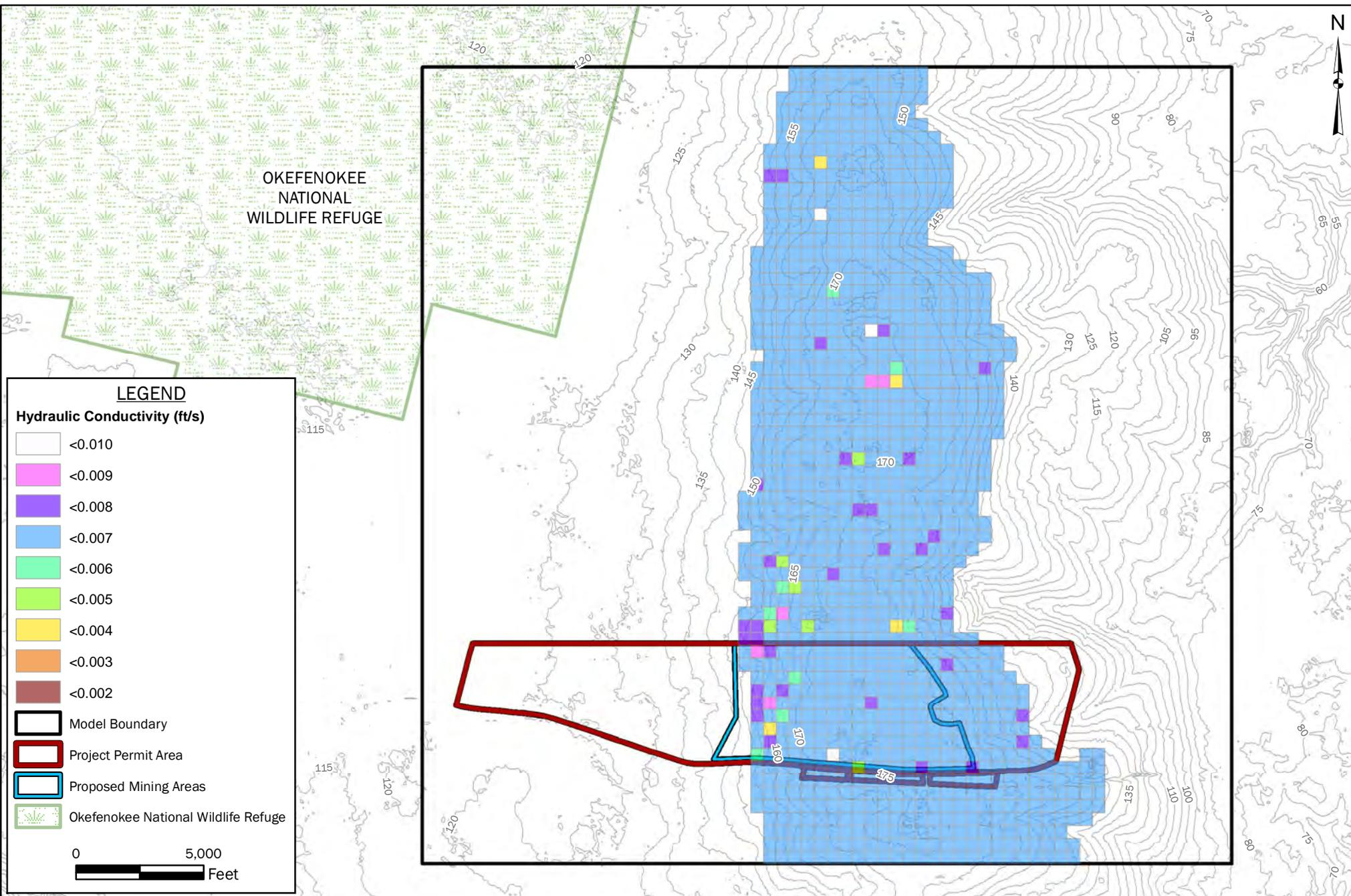
**FIGURE 17: INITIAL MODEL HORIZONTAL HYDRAULIC CONDUCTIVITY LAYER 3**
