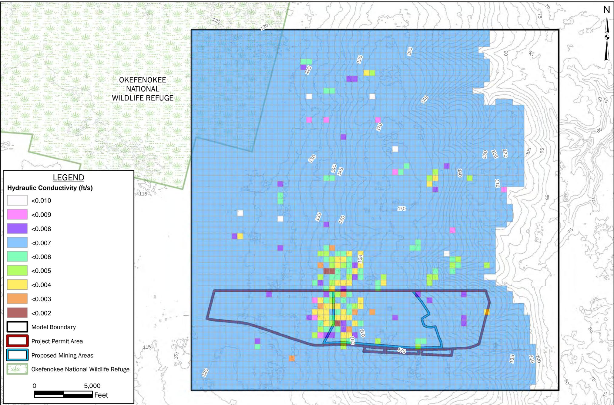
**FIGURE 21: INITIAL MODEL HORIZONTAL HYDRAULIC CONDUCTIVITY LAYER 7**
