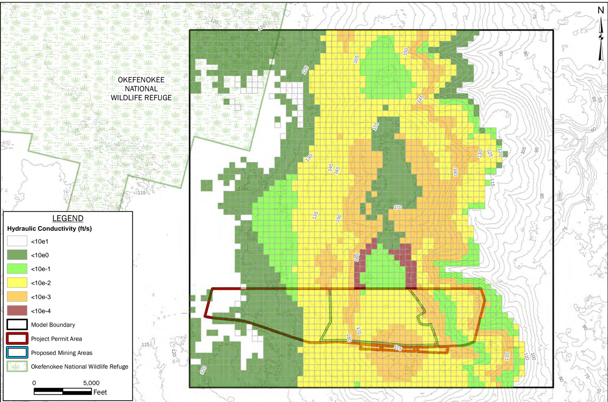
**FIGURE 37: CALIBRATED MODEL HORIZONTAL HYDRAULIC CONDUCTIVITY LAYER 6**
