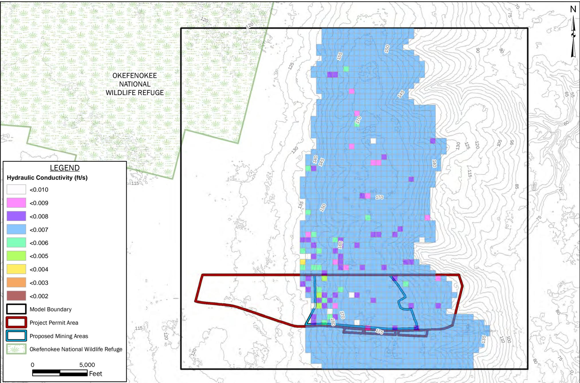
**FIGURE 18: INITIAL MODEL HORIZONTAL HYDRAULIC CONDUCTIVITY LAYER 4**
