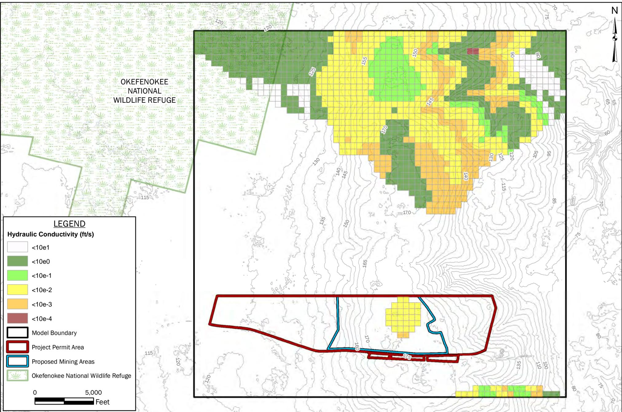
**FIGURE 44: CALIBRATED MODEL HORIZONTAL HYDRAULIC CONDUCTIVITY LAYER 13**
